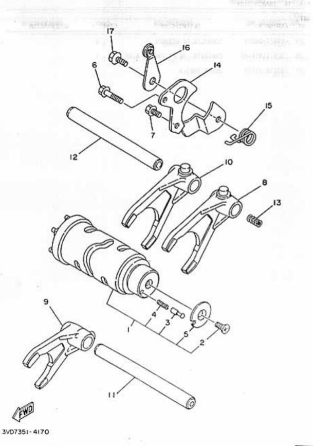
FIG. 17 LEVA DE CAMBIO. HORQ
