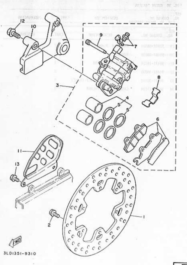
FIG. 31 CALIBRE FRENO TRASERA
