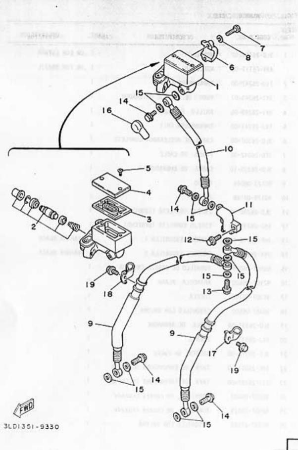
FIG. 33 CILINDRO MAESTRO DELANTERO
