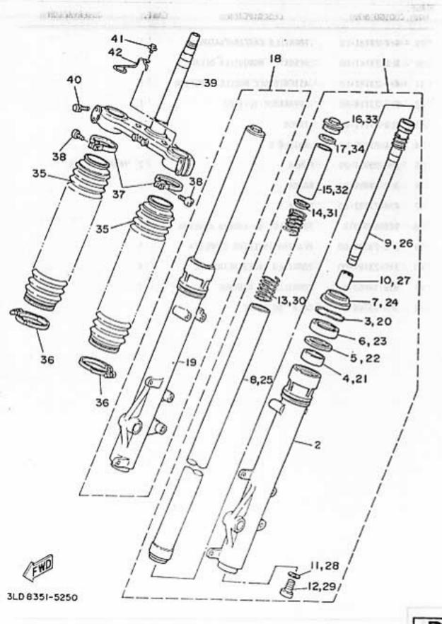
FIG. 25 HORQUILLA DELANTERA
