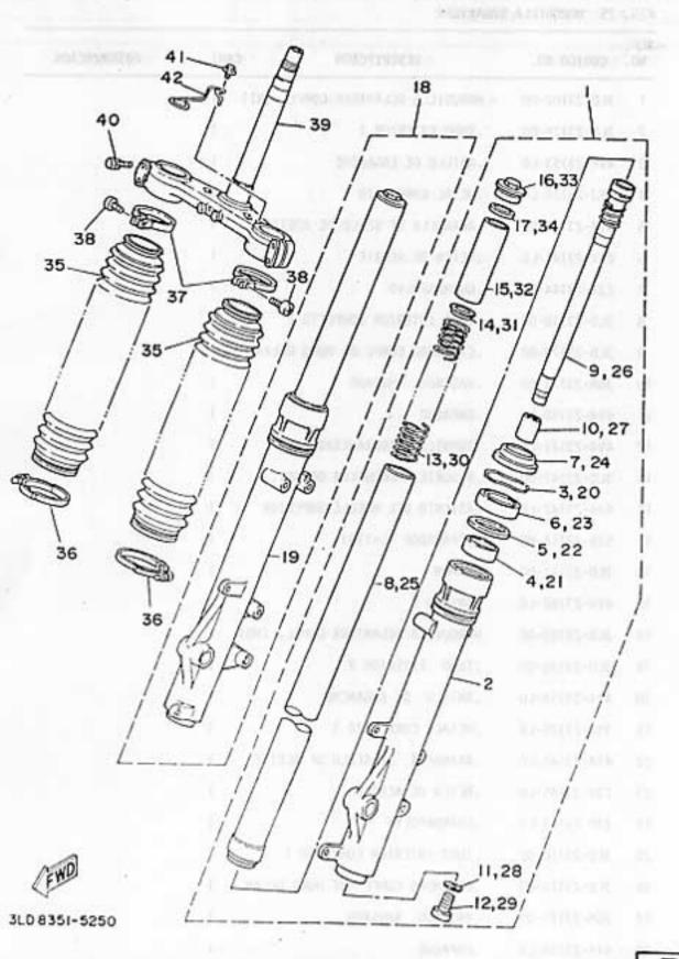
FIG. 25 HORQUILLA DELANTERA
