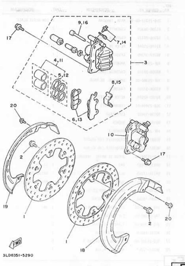
FIG. 29 CALIBRE FRENO DELANTERA
